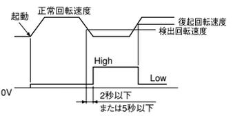
(注: SQ (R) タイプは出力波形が逆になります。アラーム設定回転速度は、定格回転速度の約半分に設定しています。詳細は納入仕様書をお取寄せの上ご確認ください。)
