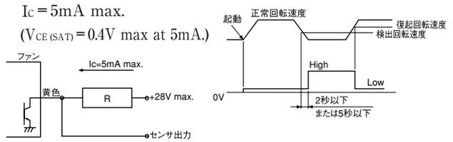
(注: SQ (R) タイプは出力波形が逆になります。) アラーム設定回転速度は、定格回転速度の約半分に設定しています。詳細は納入仕様書をお取寄せの上ご確認ください。
