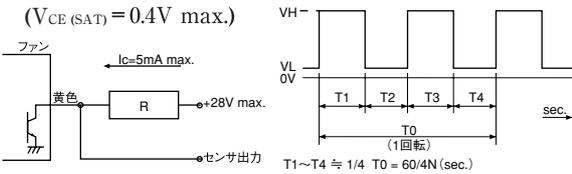
※ファン停止時の出力信号波形：停止した羽根の位置により次の2種類の波形を出力します。High一定または再起動のタイミング(0.05Hz~2Hz)のパルス出力。
